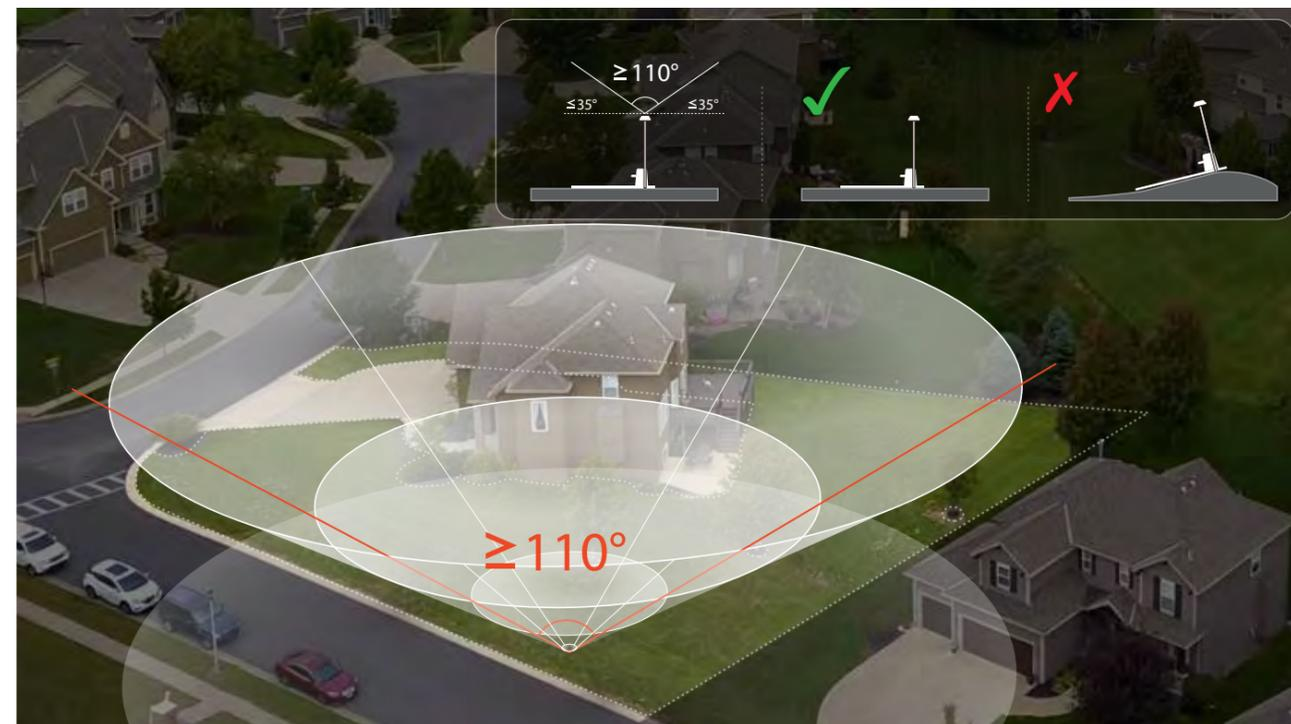
Pour obtenir un meilleur signal, vous pouvez acquérir le kit d'extension d'antenne et l'installer conformément aux instructions fournies, en veillant à conserver une orientation vers le ciel dégagée sur au moins 160°.
